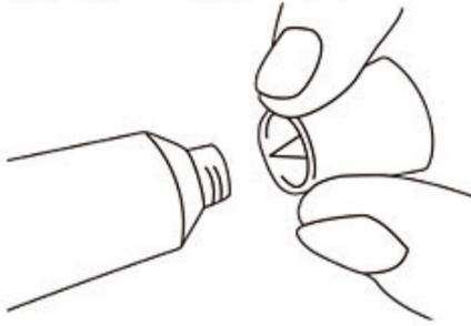
キャップ上部の突起部でチューブの出し口(アルミシール)にしっかり穴をあけてお使いください。
